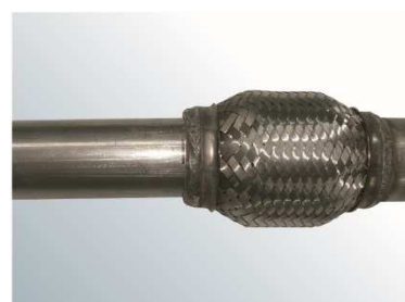
4. – 6. Anschlussrohr ca. 4 mm tief in das neue Flexrohr einschieben und dann verschweißen.
